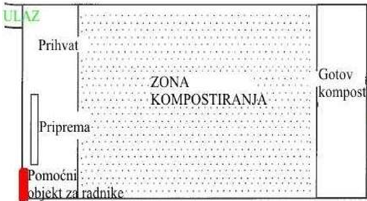
Slika 5.6.2./1. Skica kompostane s aproksimativnim iskazom dimenzija
